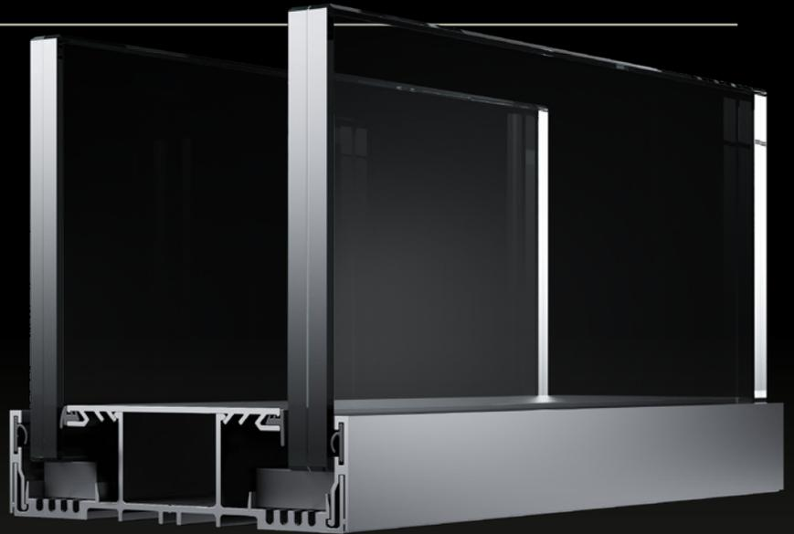
**Das IN SILENCE-System mit Doppelverglasung eignet sich überall dort, wo akustischer Komfort wichtig ist** (die Schalldämmung dieses Systems beträgt  $R_w$  53 dB). Konstruktionsprofile mit einer Breite von 125 mm und einer Höhe von 30 mm verleihen dem System einen eleganten und modernen Charakter. Die Möglichkeit, zwischen offenen oder geschlossenen Türzargen sowie verschiedenen Montageoptionen für Scharniere zu wählen, bietet Flexibilität bei der Anpassung an die Projektanforderungen.
