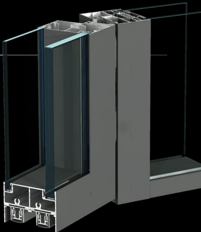
Ein Aluminiumrahmen mit einer Tiefe von 78 mm und eine Verglasung mit einer Stärke von 6 mm bis 12 mm verleihen diesen Türen einen eleganten Charakter. Die STANDARD 78-Türen können ein- oder zweiflügelig sein, mit einer maximalen Höhe von bis zu 3000 mm. Darüber hinaus werden alle Profile und Scharniere in jeder beliebigen Farbe aus der RAL-Palette lackiert, was eine Anpassung der Türen an jedes Interieur ermöglicht.
